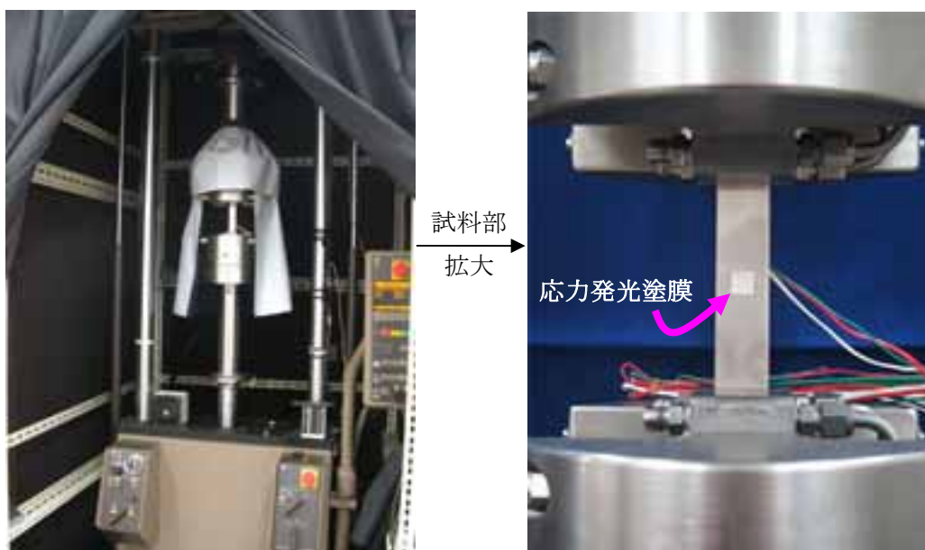
図1 左: 応力発光特性試験装置概観図 右: 応力発光塗膜センサ外観図
