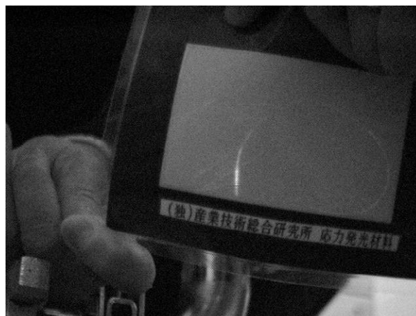
図 4: 応力発光画像計測例
