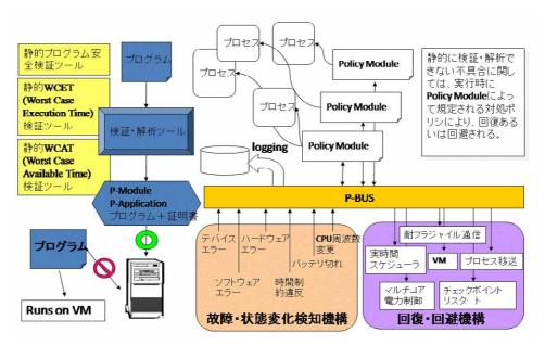
上図右側は\*-proof を支援するためのオペレーティングシステム機構の概念図である。\*-proof を実現するために、ハードウェアやソフトウェアの状態を検知する機構、検知したハードウェアあるいはソフトウェアの不具合を回復・回避する機構の大きく2つの機構を導入する。回復・回避機構は基本的な機構を提供するものであり、ポリシモジュールによって故障時の対応が決められる。P-BUS は、検知機構、回復・回避機構、ポリシモジュール、OS カーネルとの間のインターフェイスおよびシステム全体の整合性をとるためのソフトウェアモジュールである。
