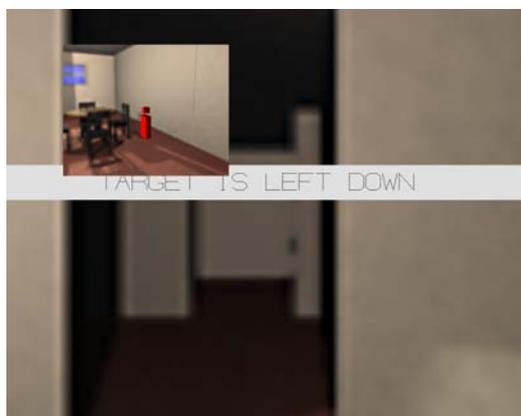
図1：バーチャルバックミラー：状況に応じて出現する視野外対象確認用インタフェース
