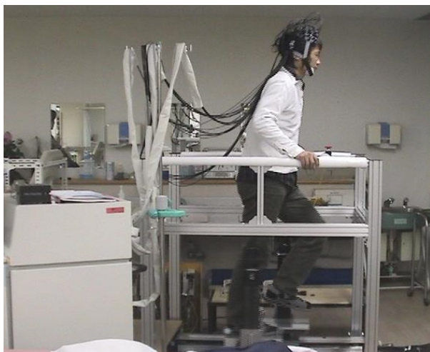
近赤外イメージング装置による 体験者の脳活動計測システム
