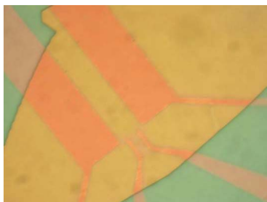
図2 張り合わせ法によって作製したルブレン単結晶電界効果トランジスタの光学顕微鏡写真。4端子電極を使用しており、電流端子間間隔は、 20\mu\text{m} である。
