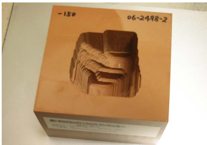
図1 筑波大陽子線医学利用研究センターで用いられているボーラス
