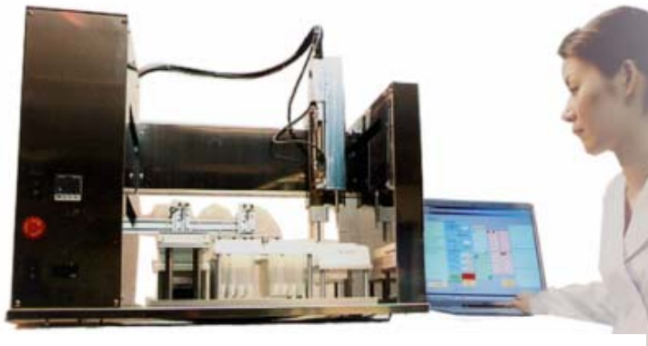
図2 結晶化ロボット“TASCAL”
