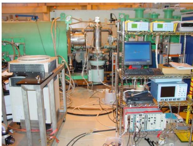
図3-9 原研3号炉（JRR-3）のSANS-JでのMgB<sub>2</sub>素子に中性子ビーム照射実験
