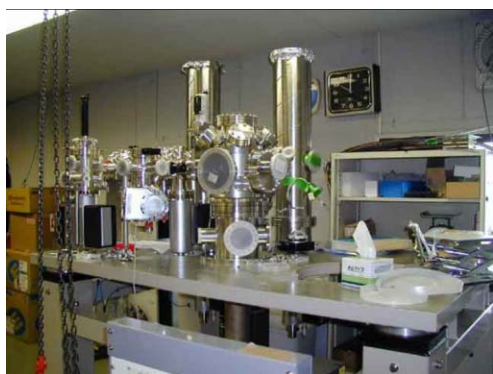
図3. 超高真空極低温ナノカンチレバーAFMの全体像とヘッド部
