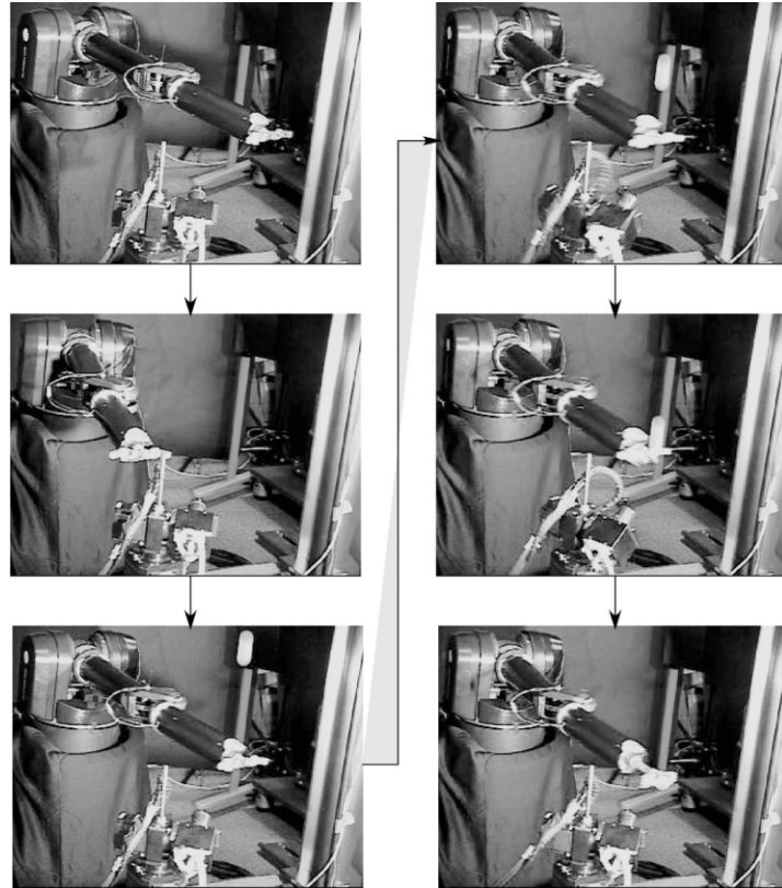
図4：高速ビジョン+高速アーム+高速キャプチャリングシステム
