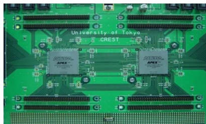
図1 FPGAで試作した論理量子プロセッサ
