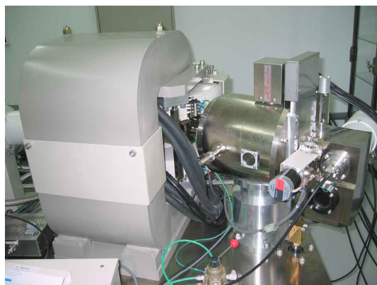
図4b. 高感度質量分析計の磁場と検出部
