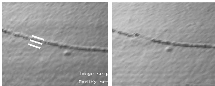
図4 カンチレバーを用いて基板に対して平行の機械的力をナノチューブに加えた結果、ナノチューブ構造が破壊されたAFM写真(左:動作前、右:動作後)
