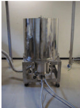
図 1 クライオスタットに組み込んだ均一磁気力発生マグネット。内径 50 mm の室温ボアが鉛直に貫通しており、6 ヶ月以上順調に連続運転し、タンパク質結晶成長に使っている。
