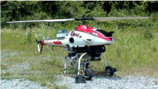
図3 RCヘリによる観測装置
