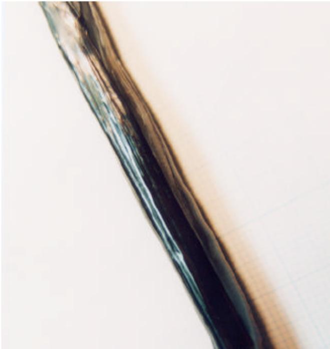
図1. 育成された $\text{Bi}_2\text{Sr}_2\text{CaCu}_2\text{O}_{8+x}$  大型単結晶の一例
