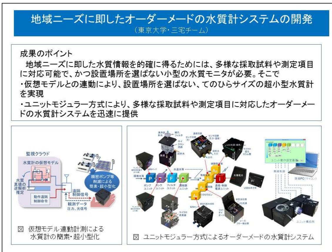
図 19 地域ニーズに即したオーダーメイドの水質計システムの開発
