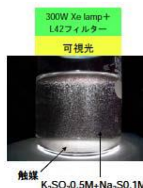
図 3-11 Black photocatalyst を用いた水素生成
