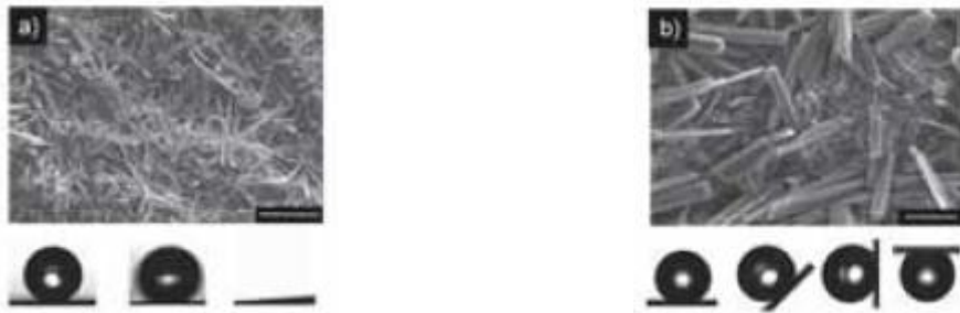
a) ジアリアルエテン結晶に紫外光を照射して 30°C で 24 時間保持した。表面はフィブリル結晶である。水滴の接触角は、 (162.9 \pm 0.8)^\circ 、滑り角は 2^\circ である(「lotus effect」)。 b) ジアリアルエテン結晶に紫外光を照射して 70°C で 3 時間保持し、さらに紫外光を照射して 50°C で 1 時間保持した。表面はロッド結晶およびフィブリル結晶である。水滴の接触角は、 (164.1 \pm 0.9)^\circ であるが、逆さにしても落下しない(「petal effect」)。
