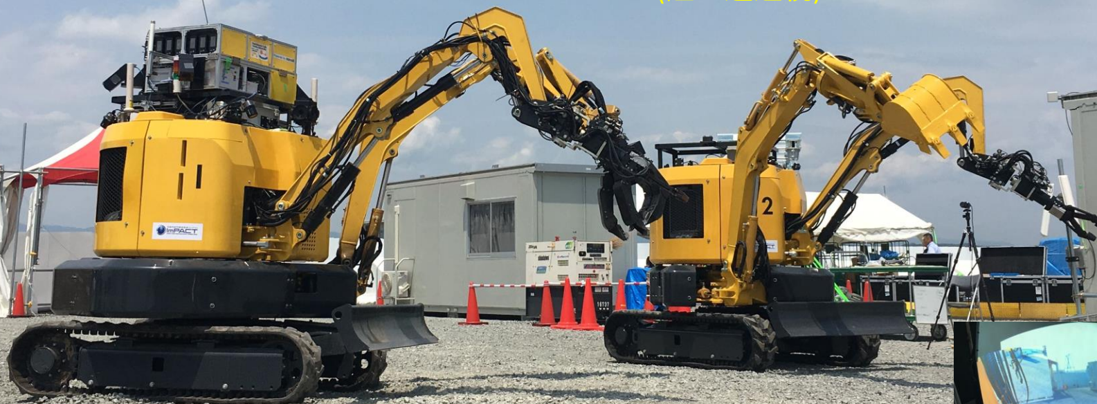
建設ロボット 1号機, 2号機 (2重旋回・複腕機構, タフ多指ハンド)
