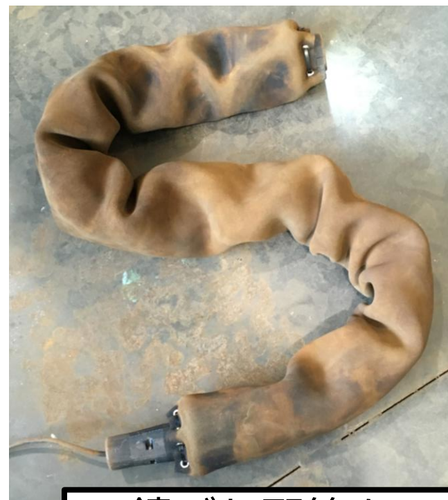
錆びた配管を 移動したロボット
