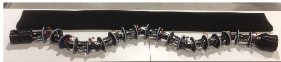
防塵防水ヘビ型ロボットの写真。上部のスポンジゴムチューブの中に、下部のロボット本体を挿入
