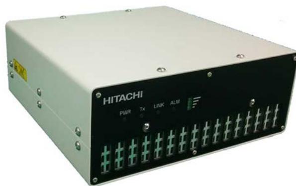
図 3 開発した ARIB STD-T103 を用いた広域 WI-RAN 多段中継装置
