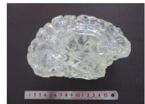
図 1 光硬化性レジン製脳表面モデルの外観
