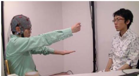
セラピーエキスパートによって施述されている被験者の脳活動を EEG を用いて計測した（左写真は施述中の脳活動計測実験の様子）。 $\theta$ 、 $\alpha$ 、 $\beta$  の各帯域におけるパワーを周波数分析によって算出した結果、各被験者の被暗示性の高低によるパワー値の差を発見することができた。この結果は、セラピーノービスの訓練方法や、セラピーロボットを構築する上での足がかりとなりえる。左下図は、被暗示性によるシータ波のセッション中のパワーをしましたものである。
