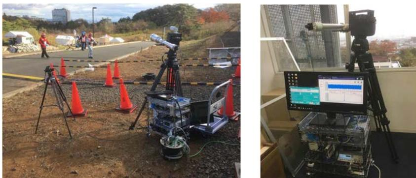
図2 組み立てたドップラー・ライダー本体と望遠鏡部
