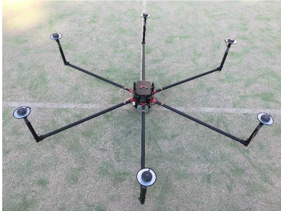
図1 改良型複数 GNSS アンテナ搭載の三次元計測システム
