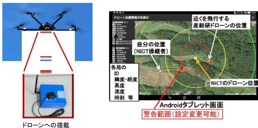
図2 ドローン間の位置情報共有技術試作システム
