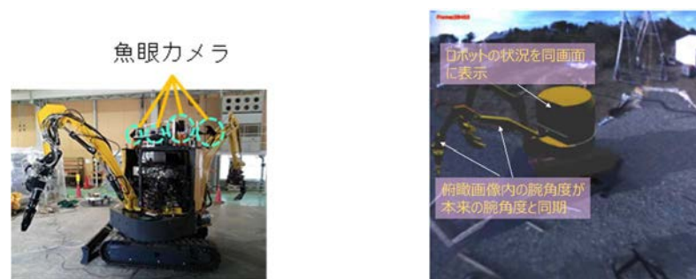
図 1 俯瞰画像（左：ロボットに搭載したカメラの配置，右：任意視点俯瞰画像）
