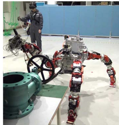
図 2 WAREC-1 でのバルブ回し
