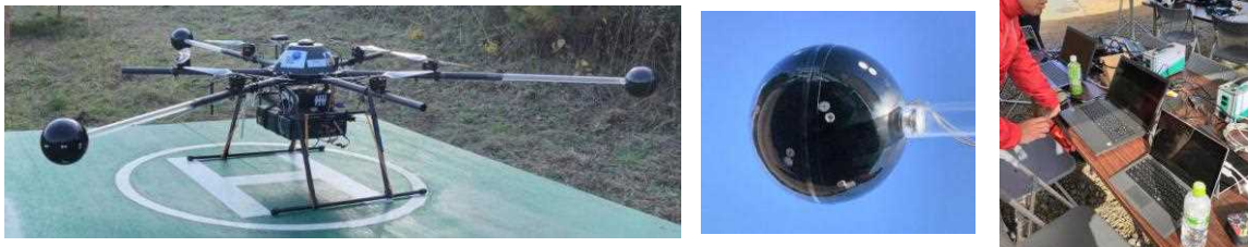
センサシステム統合 UAV (左) と搭載用マイクアレイ (中央)、地上局 (右)
