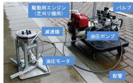
図 1 減速機一体型油圧モータ
