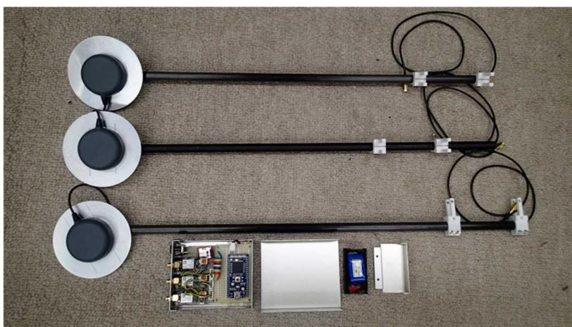
図 2 プロトタイプの GNSS アンテナシステム
