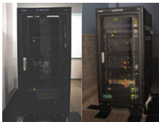
サイバーセキュリティ・ファクトリーに設置された量子鍵配送装置（左：送信機、右：受信機）
