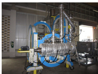
新バイオディーゼルHiBDの製造法 パイロットプラント (200 L/D) 原料(EFB搾り油)と製品(HiBD)
