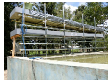
スポンジ傾斜ろ過装置
