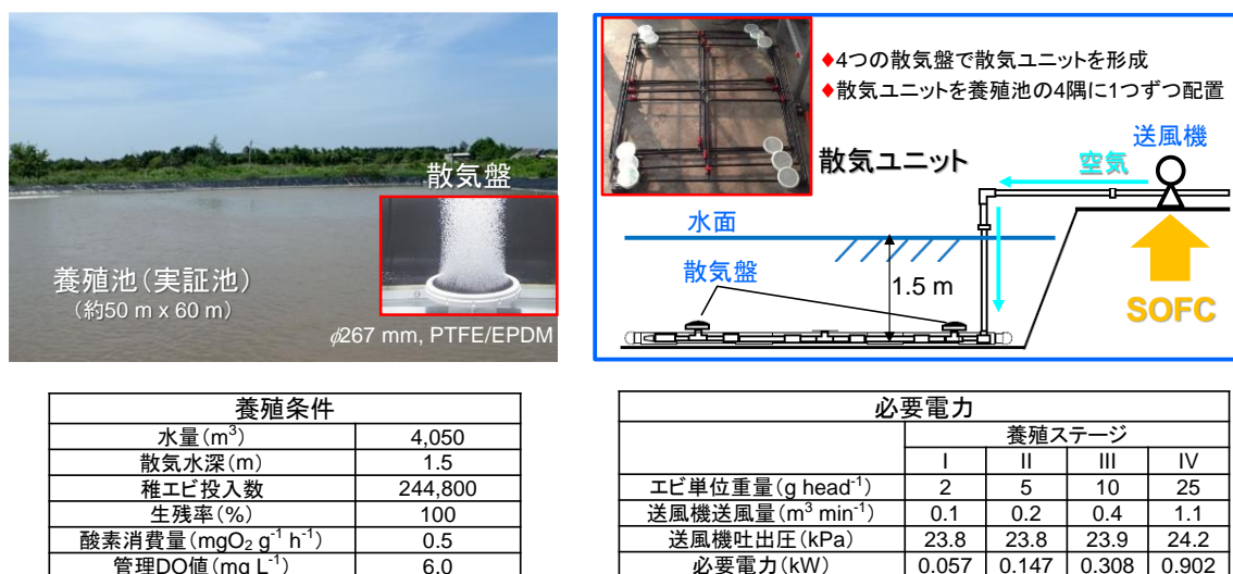
図 16 : 微細気泡散気装置を導入した省エネ曝気システム ; (左表) 養殖条件、(右表) 各養殖ステージの必要電力
