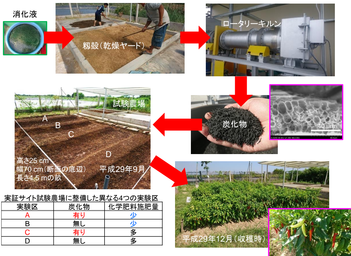
図 20：メタン発酵槽実証機から排出される消化液および現地未利用バイオマス（籾殻）を原料とした炭肥料の製造および炭肥料を用いた実証サイト試験農場におけるトウガラシの栽培
