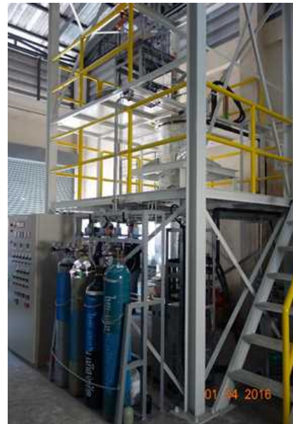
平成 28 年 1 月に JGSEE/KMUTT へ導入したドロップチューブ炉 (0.1 kg/h)
