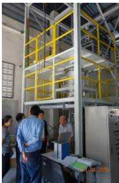
平成 28 年 1 月に JGSEE/KMUTT へ導入したドロップチューブ炉 (0.1 kg/h)
