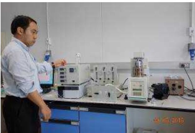
熱天秤と熱天秤用水蒸気導入装置
