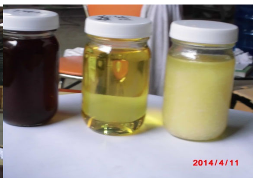
図3-5 固形分の混ざった粗油から高品質 BDF の製造
