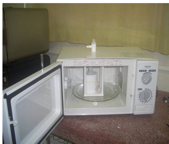
図 3-2 マイクロ波加熱グリセリン精製装置
