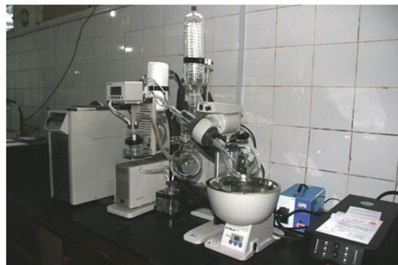
本プロジェクトで新規に導入した最新型のロータリーエバポレーターについて技術移転を行った。従来型（左）と比べ、全ての操作がシステム制御されており、操作中その場に拘束されず、他の作業が出来るメリットが生じた。
