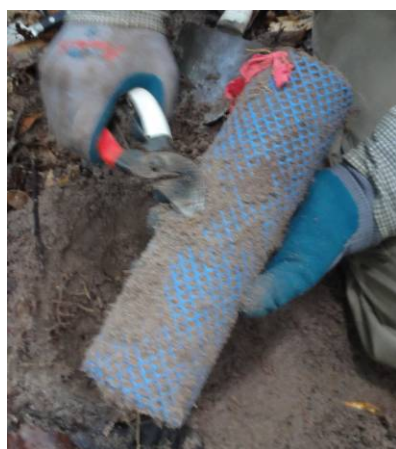
写真 3 (左) 細根の成長量を測定するためのイングロスコア. (右) 細根をスキャナで直接観察するためのアクリルケース.
