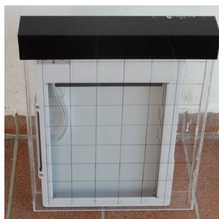
写真 3 (左) 細根の成長量を測定するためのイングロスコア. (右) 細根をスキャナで直接観察するためのアクリルケース.
