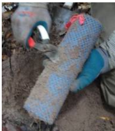
写真3 (左) 細根の成長量を測定するためのイングロースコア。(右) 細根をスキャナで直接観察するためのアクリルケース。
