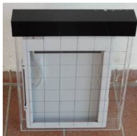
写真3 (左) 細根の成長量を測定するためのイングロースコア。(右) 細根をスキャナで直接観察するためのアクリルケース。
