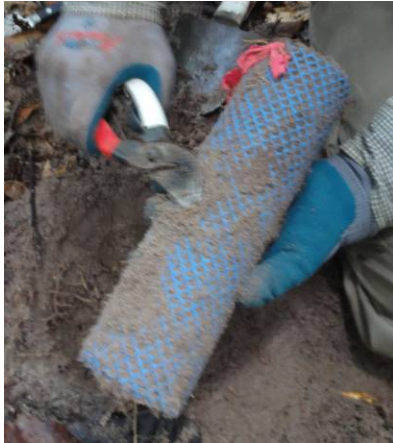
写真3 (左) 細根の成長量を測定するためのイングロースコア。(右) 細根をスキャナで直接観察するためのアクリルケース。
