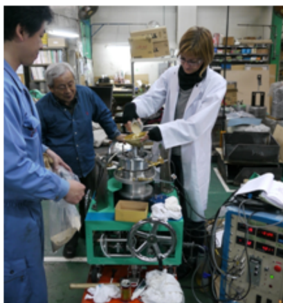
図 2 試作試験中のポータブル非排水リングせん断試験 (JICA-JST 報告会資料より)
