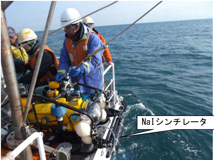
NaIシンチレータ、CTセンサー及び音響測位装置を搭載した三井：RTV-500MK2
