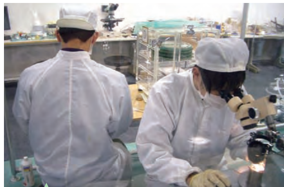
ショッカクチップを製造するクリーンルーム。MEMS技術による微細加工が最小・最薄・最軽量の3軸触覚センサを実現している。
