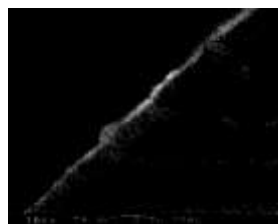
図 4 InAs マスクを用いた真空一貫プロセスにより形成した V 溝エッジ量子細線構造の断面 SEM 像
