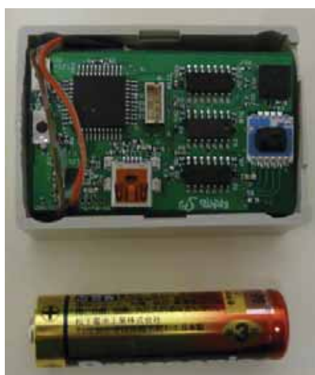
人体装着センサの市販素子によるプロトタイプと測定例
