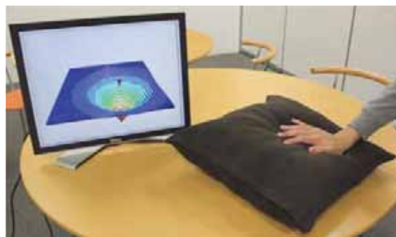
図1 反射型光センサによる柔軟物体の接触位置とその圧力の認識
