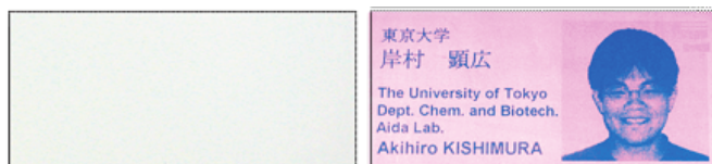
図4 紫外光下でのみ印刷情報が読み取れるセキュリティペーパー(左:室内光, 右:紫外光)
