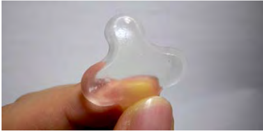
図 29 粘土と dendrimer binder からなる高含水水ゲル (アクアマテリアル)
