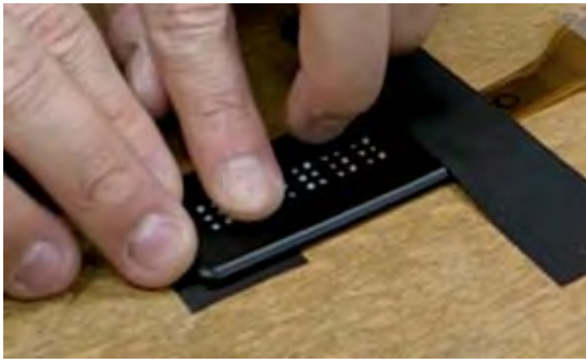
図 40 カーボンナノチューブ高分子アクチュエーターを用いた薄くて軽いフィルム状の点字ディスプレイ
